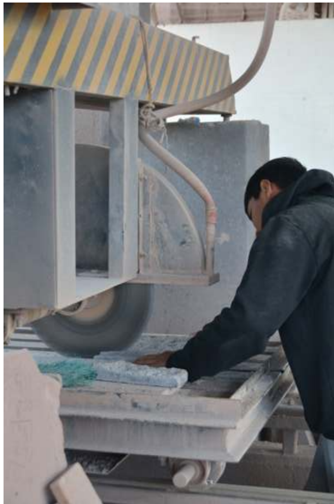
Figura 10. Máquina laminadora para cortes finos de cantera
